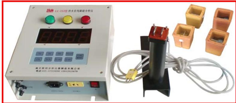
浇样温度 TM、液相线温度 TL、固相线温度 TS。解决了常规分析仪器不能满足炉前快速分析的时间要求问题，以满足铸造生产的质量控制要求
